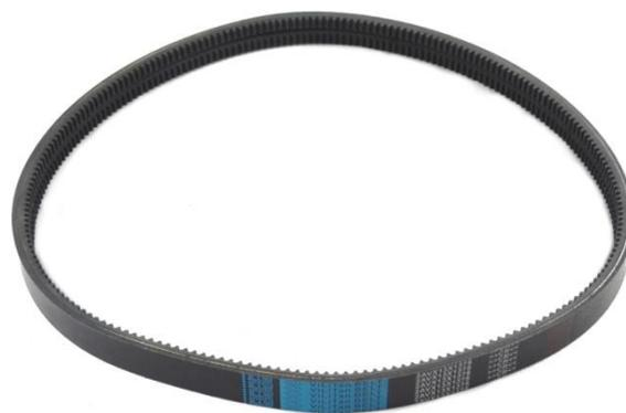
Эти ремни используют при возникновении пульсирующих или резких нагрузок, ведущих к нестабильной работе обычных клиновых ремней. Объединение нескольких ремней в единое целое с помощью ленты гарантирует устранение проблем, связанных с биением, скручиванием или переворотом. В итоге, четкое движение ремня по дорожке шкива гарантирует долгий срок его службы. Многоручьевые клиновые ремни VILITAN могут использоваться с типами шкивов по стандарту ISO.
